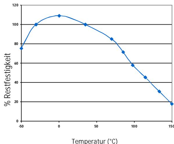
„Hitzebeständige“ Scherfestigkeitsversuche wurden auf Weichstahl durchgeführt. Aushärtung bei Raumtemperatur über 24 Stunden. Vor den Testversuchen wurden die Teile über 30 Minuten auf der Testtemperatur gehalten.
