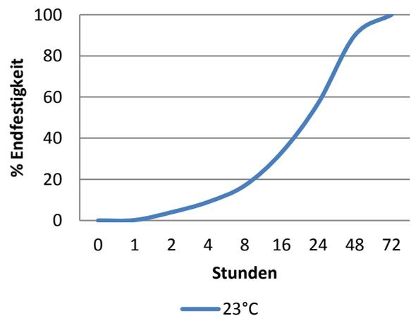
Das Diagramm zeigt den typischen Aufbau der Festigkeit bei der Verklebung von Probestücken bei 23°C. Aushärtung bei höheren oder niedrigeren Temperaturen beeinflusst die Aushärtegeschwindigkeit.
