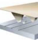
Die Kornspitzen der Dreiecke brechen beim Schleifprozess und es entstehen neue, scharfe Spanten entlang der vorgegebenen Spankanten. Die Oberfläche des Materials wird durch neue Schneidspitzen bearbeitet. Das Resultat ist ein schneller, kühlender Schleifprozess und eine verlängerte Standzeit des Schleifmittels.
