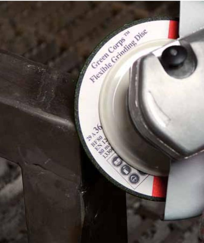
**Ergonomie Schruppscheibe** (dünn), die unvergleichbar leise mit hoher Schnittigkeit zerspannt. Mehrere Green Corps Scheiben im Einsatz erscheinen leiser als eine konventionelle Schruppscheibe.
