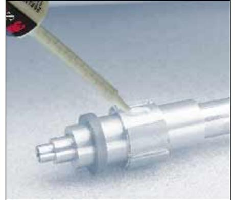
Kleben eines Magneten an einen Stahlrotor
