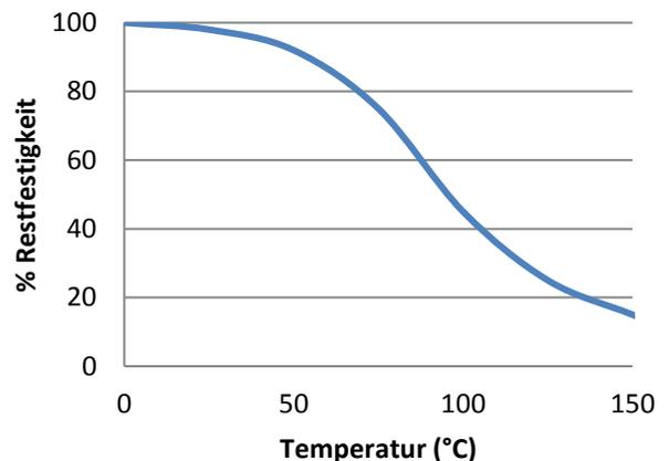
„Hitzebeständige“ Scherfestigkeitsversuche wurden auf Glas auf Weichstahl Klebeverbindungen durchgeführt. Vor den Testversuchen wurden die Teile über 30 Minuten auf der Testtemperatur gehalten. UV640 kann bei geringen Belastungen kurzzeitig auch höheren Temperaturen ausgesetzt werden (z.B. bei Einbrennlack- oder Schwall-Löt-Verfahren). Niedrigste Temperatur bei Endfestigkeit: -55°C (abhängig von den verwendeten Materialien).
