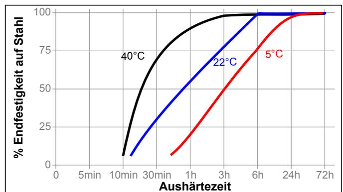
**Aushärtegeschwindigkeit in Abhängigkeit vom Aktivator**
